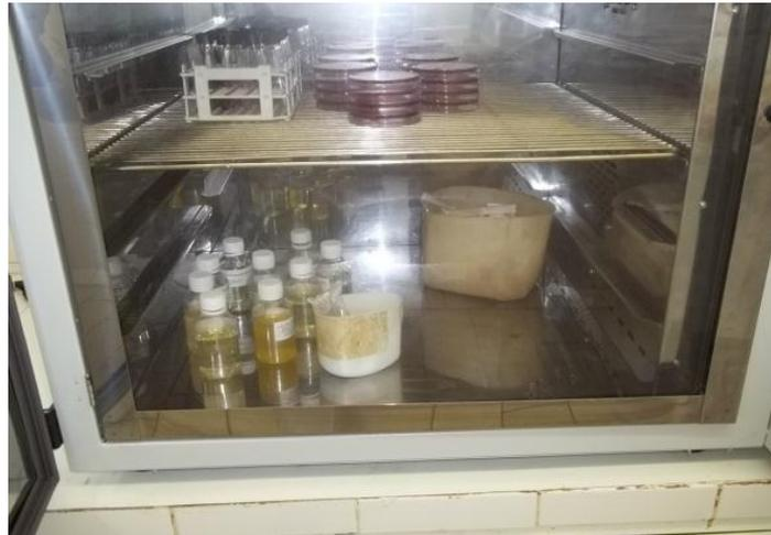
**Figura 4.** Pré-enriquecimento: Processo de incubação em estufa.
