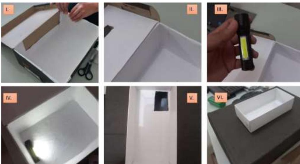
**Figura 4.** Detalhes da “câmara” desenvolvida para captura das imagens. I. – Preenchimento do interior em branco; II. – Revestimento finalizado; III. – LED utilizado para iluminação no interior da caixa; IV. – Local de inserção do LED para iluminação completa do interior da caixa; V. – Espaço fixado para inserção do celular (equipamento de captura das imagens; VI. – Visualização de fora da caixa.
