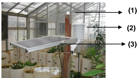
Figura 4. Sensor de radiação solar (1), umidade relativa e temperatura do ar (2) e placa solar (3) para geração de energia ao sistema de aquisição de dados.
