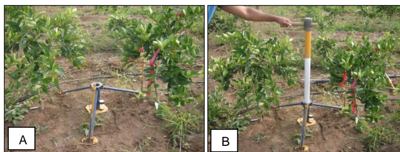
Figura 1. A - Base niveladora para instalação do tubo de FDR (Reflectometry Domain Frequency). B - Introdução do tubo de FDR com comprimento de 0,50 m entre plantas de limeira ácida 'Tahiti' [ C. latifolia (Yu. Tanaka) Tanaka].
