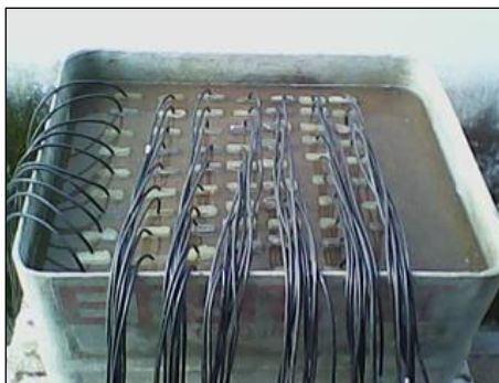
Figura 1. Testes de sondas de TDR (Time Domain Reflectometry) com determinação da constante dielétrica ( K_a ) em caixa de areia saturada.
