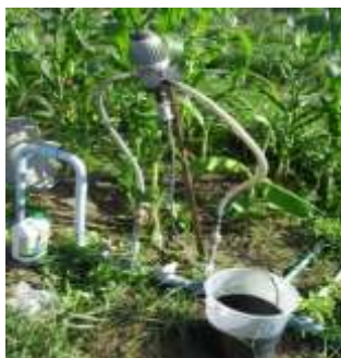
Figura 2. Aplicação das substâncias húmicas através de um venturi. Foto: Djalma dos Santos.
