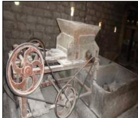
Figura 08 e 09: Prensa manual e cevadeira elétrica - Casa de farinha tradicional/mecanizada do Senhor Roque em Queimadas Nova. Fonte: Registro fotográfico realizado pela autora em trabalho de campo, outubro de 2013.
