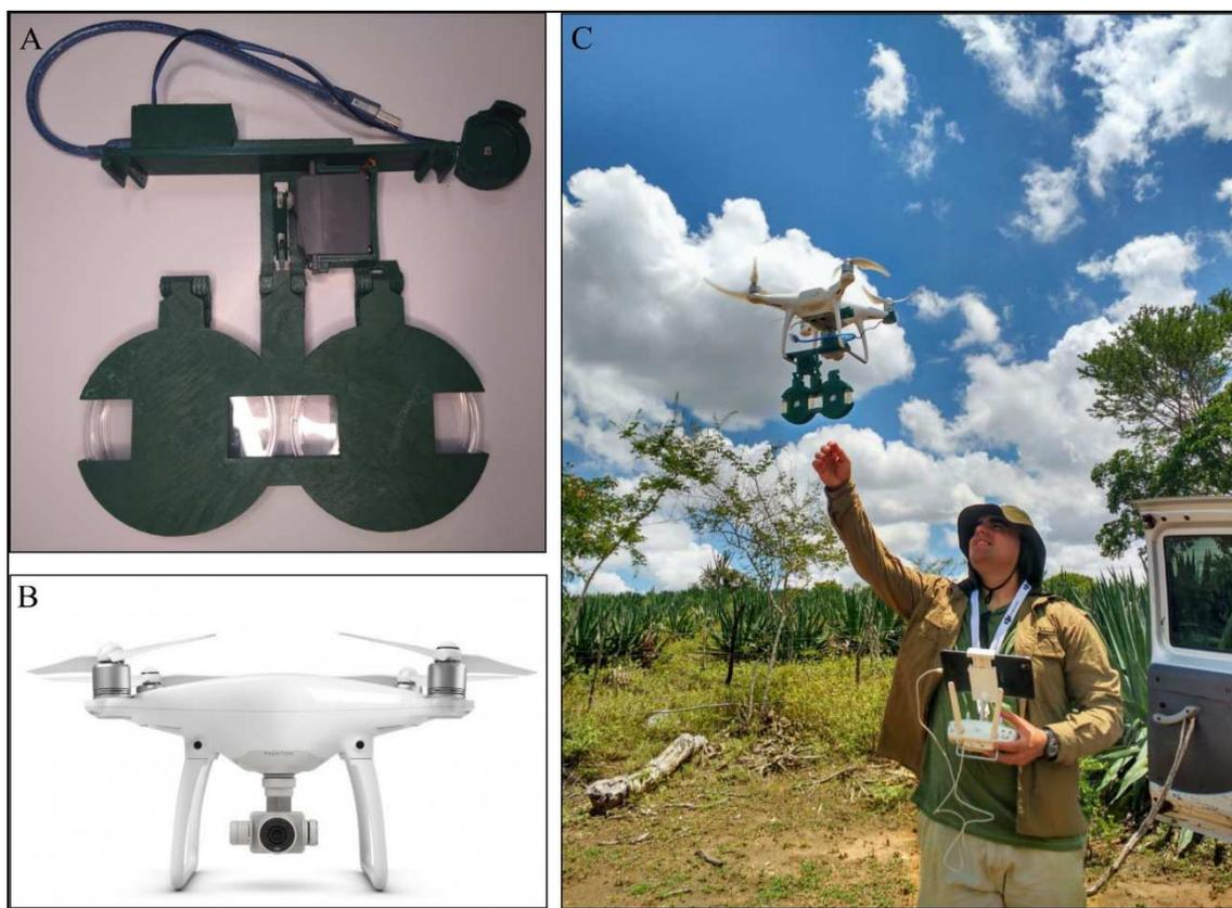
**Fig. 3:** Coletor aeromicrobiano desenvolvido em parceria com o grupo de tecnologias educacionais, robótica e física da Universidade Federal do Recôncavo da Bahia (G-TERF/UFRB), com duas placas de Petri descartáveis, medindo 9cm de diâmetro com meio de cultura e tampa encaixadas (A), VANT multirrotor modelo phantom 4 advanced (B) e Trabalho de campo de amostragem aerobiológica com o coletor aeromicrobiano acoplado ao VANT phantom 4 advanced (C).
