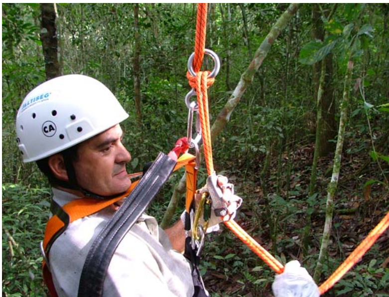
Figura 11. Detalhes do instrutor com freio em oito e blocante Shunt instalados corretamente em seu peitoral.
