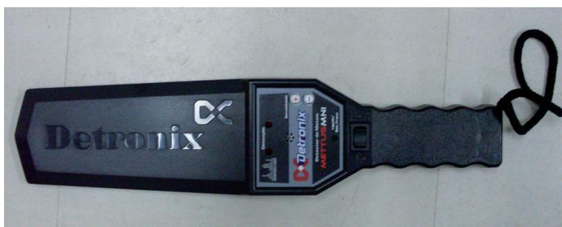
Figura 4.6 – Detector de metais utilizado no recebimento das caudas de lagosta.
