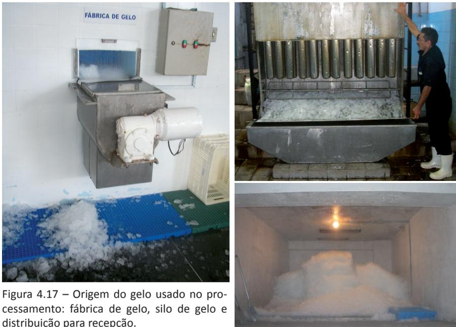
Figura 4.17 – Origem do gelo usado no processamento: fábrica de gelo, silo de gelo e distribuição para recepção.
