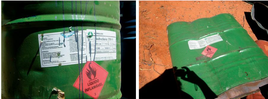
Figura 2.29 – Tambor utilizado na confecção da marambaia, destacando sua condição prévia de depósito de produtos químicos tóxicos.
