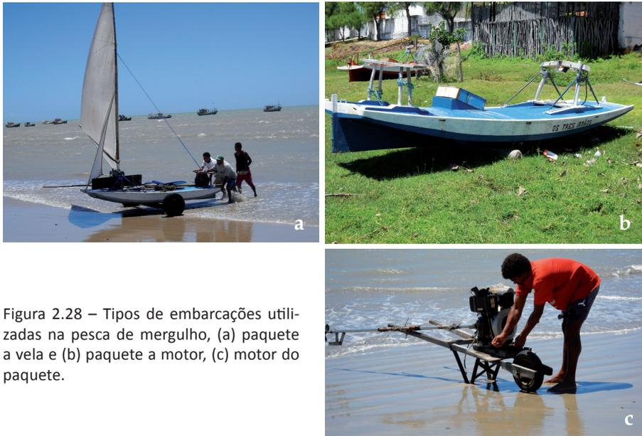
Figura 2.28 – Tipos de embarcações utilizadas na pesca de mergulho, (a) paquete a vela e (b) paquete a motor, (c) motor do paquete.
