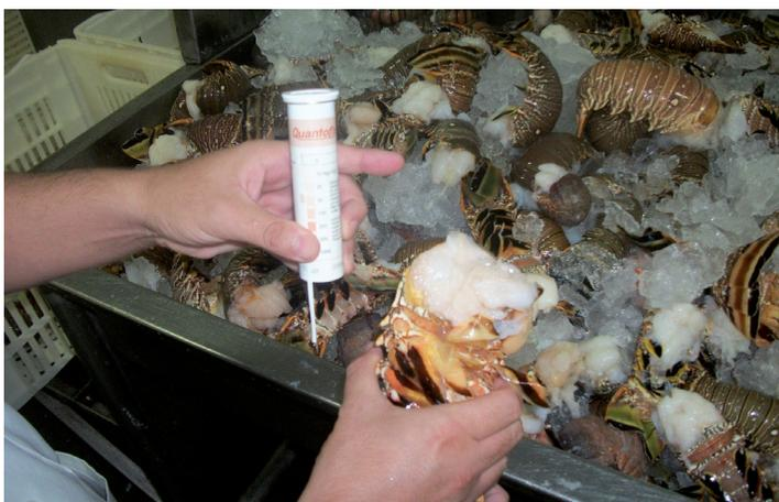
Figura 4.5 – Fita utilizada para a determinação preliminar do teor de  $\text{SO}_2$  na cauda de lagosta.
