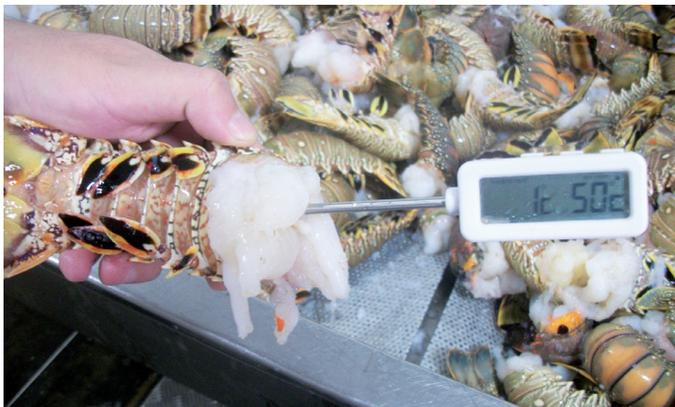
Figura 4.4 – Termômetro de haste longa (tipo “espeto”) para aferir a temperatura da cauda de lagosta.
