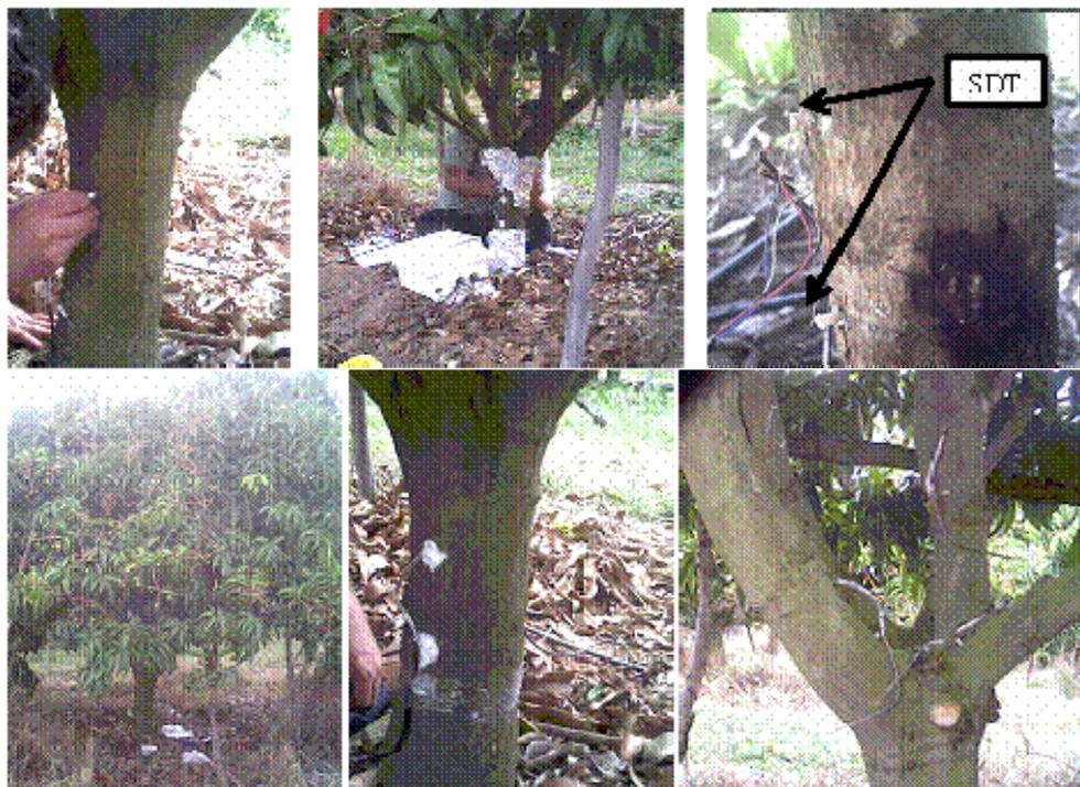
Figura 8. Instalação de uma sonda de dissipação térmica (SDT) no tronco e ramos de planta adulta
