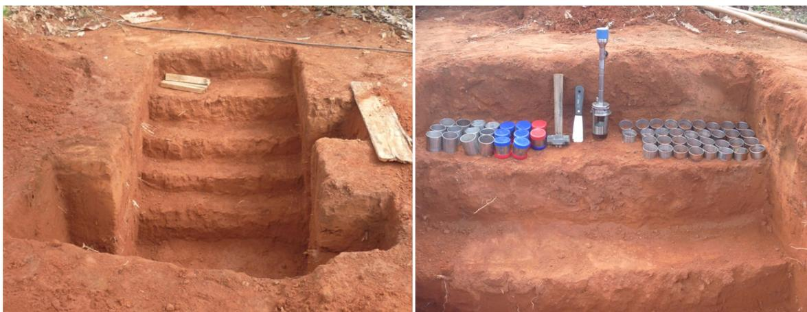
**Figura 2** - Trincheira aberta no campo para a retirada das amostras de solo.
