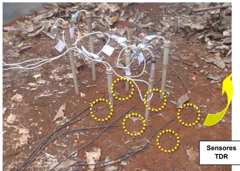
**Figura 3** - Esquema de instalação das guias de onda (TDR) para o monitoramento da umidade ao longo do período.
