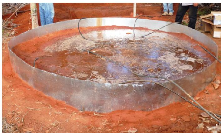
**Figura 2** - Processo de saturação do perfil do solo.
