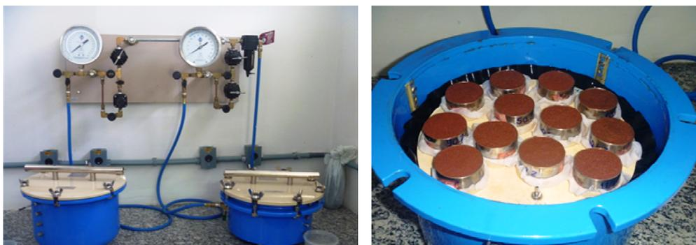
**Figura 4** - Extrator de RICHARDS e amostras dentro da panela de pressão.
