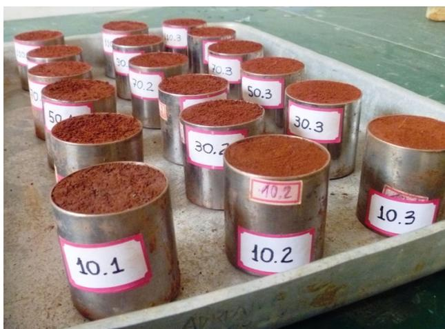
**Figura 3** - Amostras indeformadas de solo para a determinação da densidade do solo.
