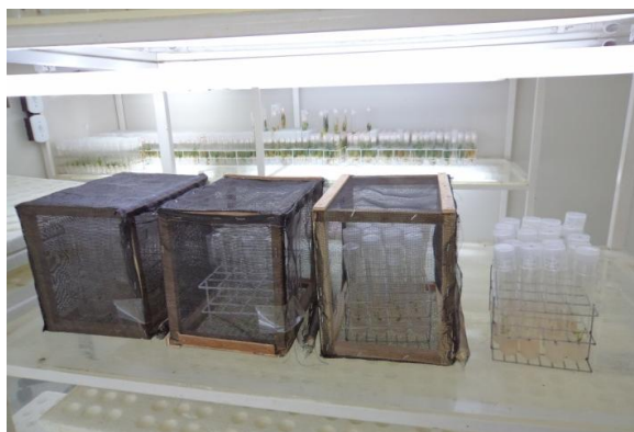
Figura 1. Detalhe da caixa de madeira com paredes revestidas por sombrite
