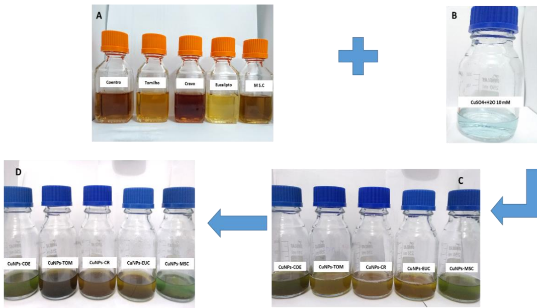
Figura 1 - Indicação de cor da síntese e de nanopartículas de cobre A) extrato aquoso; B) solução de \text{CuSO}_4 \cdot 5\text{H}_2\text{O} (10mM); C) Alteração da cor dos extratos 1h após a adição de \text{CuSO}_4 \cdot 5\text{H}_2\text{O} ; D) Alteração da cor dos extratos após reação de síntese e autoclavagem ( 120^\circ\text{C}/15\text{min} ).
