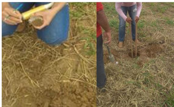
**Figura 3.** Coleta de amostras indeformadas nas linhas do rodado do trator para avaliação dos atributos físico-hídrico de um Latossolo Amarelo discrocoeso.
