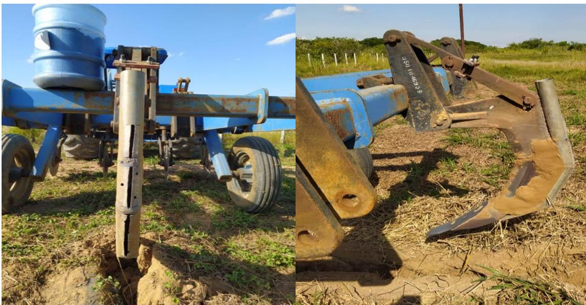
**Figura 3.** Implemento alternativo acoplado no subsolador para distribuição de condicionador de poros ao longo do sulco de subsolagem.
