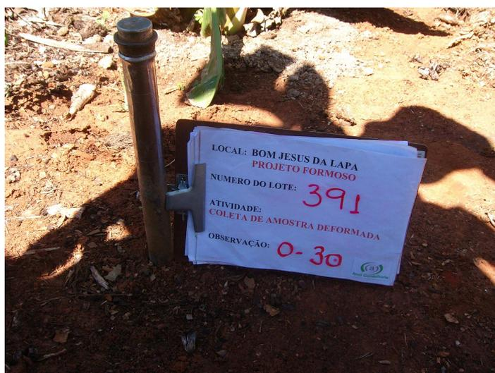
Figura 4 – Coleta de amostra de solo deformada.
