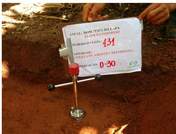
Figura 4 – Coleta de amostra de solo indeformada.
