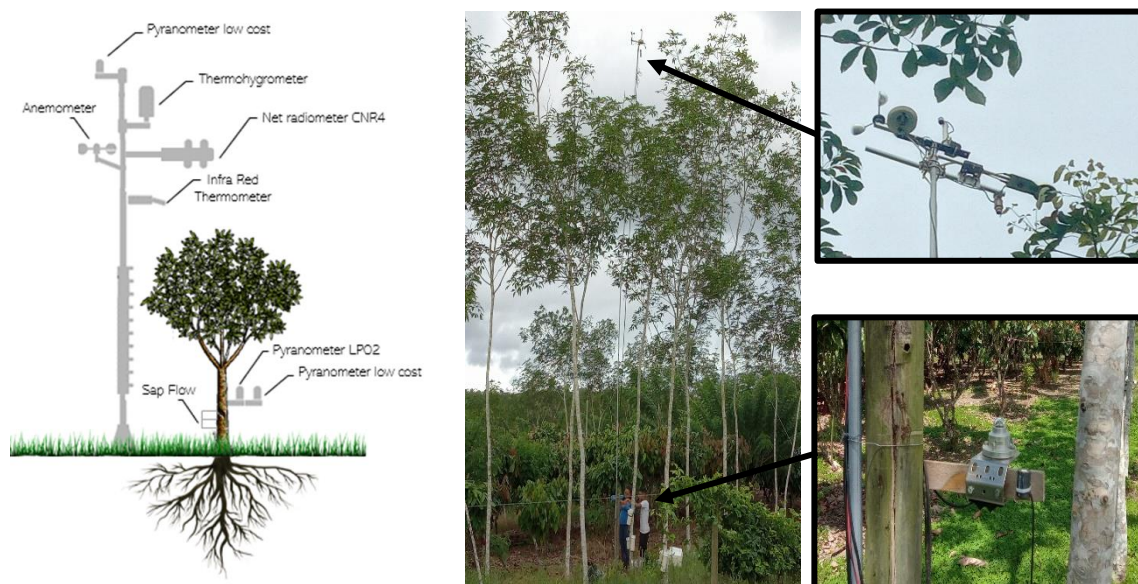
Figura 2. Representação esquemática da alocação dos instrumentos de medição na seringueira (à esquerda) e a direita os instrumentos já instalados
