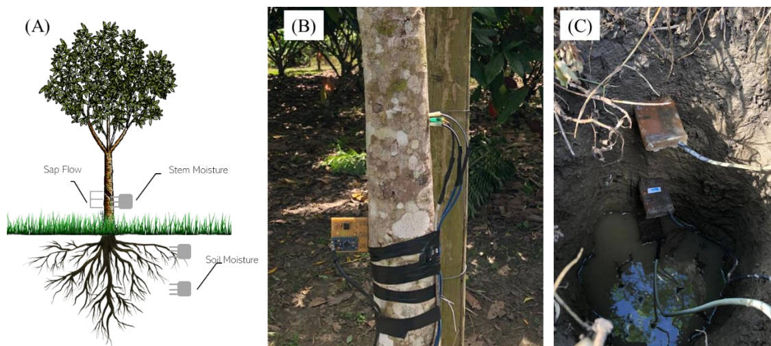
Figura 5. (A) Representação esquemática da alocação dos instrumentos de medição na seringueira; (B) Sensores de umidade do caule e fluxo de seiva em funcionamento; (C) Sensores de umidade do solo no durante a instalação
