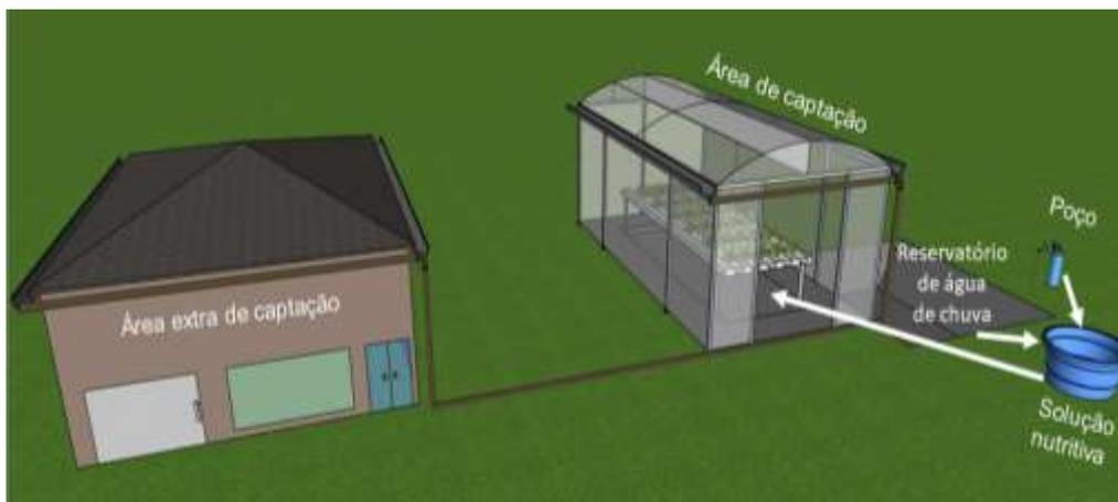
**Figura 2.** Esquema simplificado de representação do sistema de produção hidropônica, acoplado à captação pluvial associada a área extra com a contribuição da água de poço.
