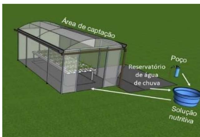
**Figura 3.** Esquema simplificado de representação do sistema de produção hidropônica, acoplado à captação pluvial associada à água de poço.
