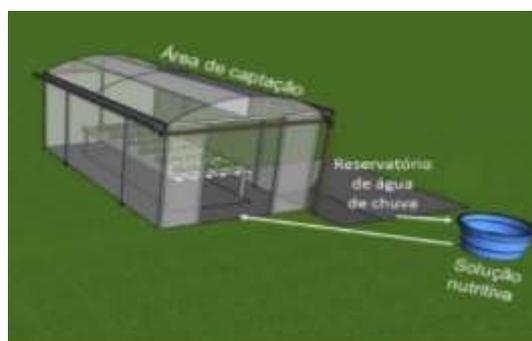
**Figura 1.** Esquema simplificado de representação do sistema de produção hidropônica, acoplado à captação pluvial (A).
